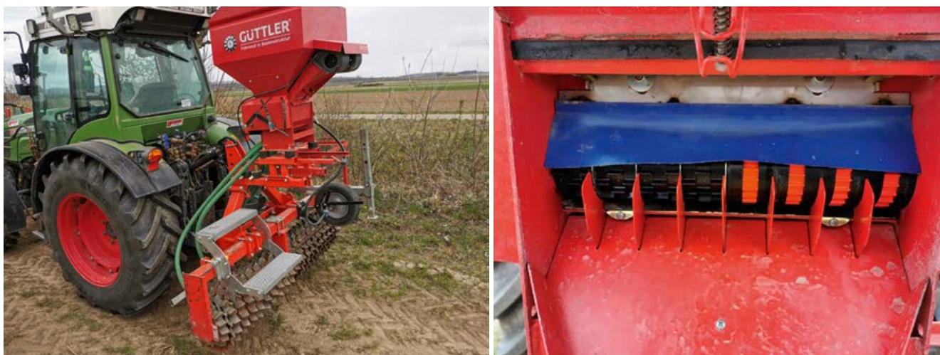
Abb. 2: Anbaurahmen mit geteiltem Saatkasten mit Cambridgewalze (links); Blick in den Säkasten mit verschiedenen Säwellengrößen (rechts)
